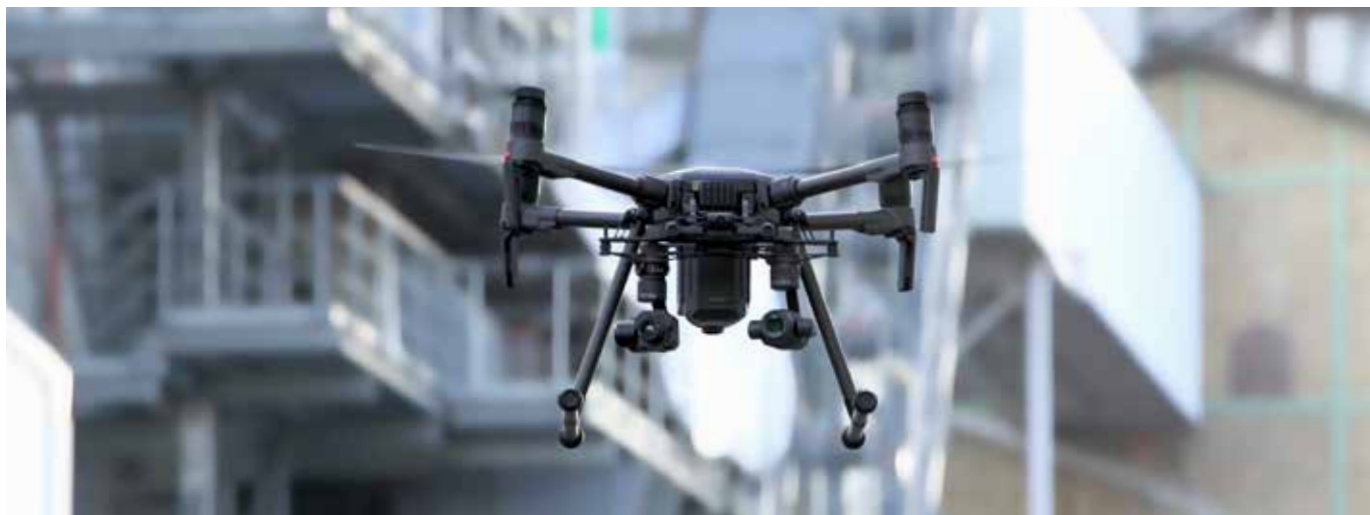
Drohneinsatz im Industriepark zur Erkennung von Undichtigkeiten an Rohrbrücken oder Verschleißerscheinungen an Fassaden und Kaminen.
