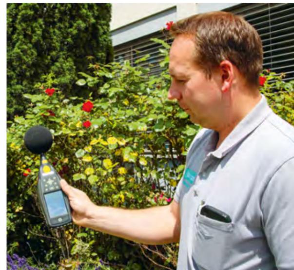
Marco Busse, zuständig für den ISW-Immissionschutz Geräusche, bei einer Messung von Geräuschemissionen im Industriepark.
